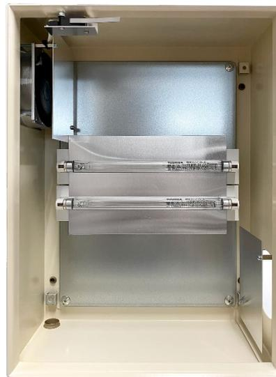
機械の内部に紫外線灯6W2灯が設置されています。内蔵のファンで室内の空気を吸い込み紫外線の中を透過させ、室内に戻すことで、**紫外線(UV-C)**のエネルギーを取り込んだ空気全てに大量に浴びせ、空気中のウイルスを不活化しています。
